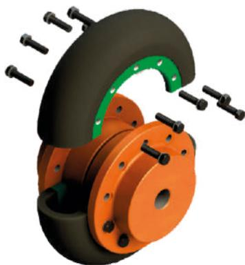
**Aplicação:** Elemento elástico bipartido, facilita a manutenção, quando as pontas dos eixos são muito próximas. Capacidade de absorção de desalinhamentos angulares e amortecimento de vibrações, possibilitando a manutenção de elemento elástico sem a remoção da flange.
