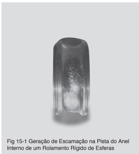
Fig 15-2 Geração de Escamação na Pista do Anel Interno de um Rolamento Rígido
