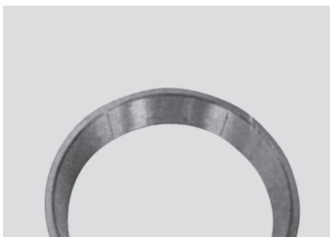
Fig. 15-7 Marcas de Entalhe na Pista do Anel Externo de um Rolamento de Rolos Cônicos
