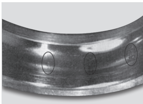
Fig. 15-8 Entalhe e Escamação na Pista do Anel Externo de um Rolamento Rígido de Esferas
