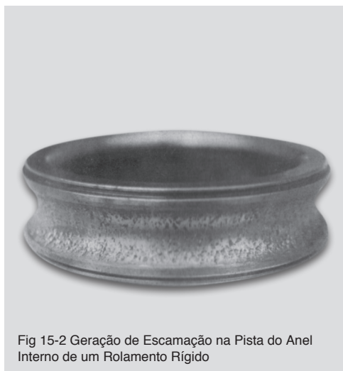
Fig 15-1 Geração de Escamação na Pista do Anel Interno de um Rolamento Rígido de Esferas
