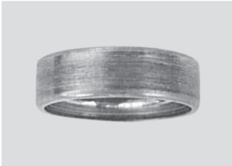
Fig. 15-9 Deslocamento na Superfície do Anel Externo de um Rolamento Rígido de Esferas
