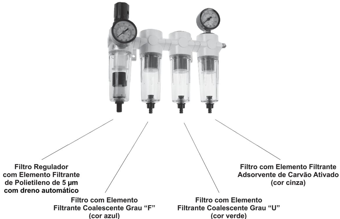
**Filtro Regulador:** mantém a pressão de operação constante, independente das flutuações da pressão primária e do consumo de ar; pré-filtragem dos filtros coalescentes, retendo as partículas sólidas e gotas de umidade com valor absoluto de 5 µm.
