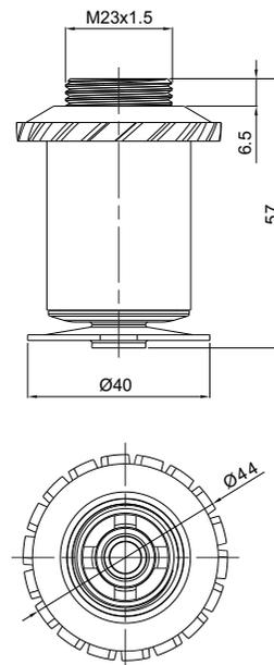
1101-30-05 Elemento Filtrante Mini 05  $\mu$  (polietileno)
