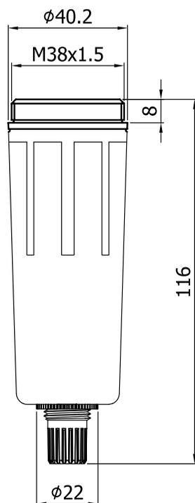
24208-11-CDN Conjunto Copo Mini Policarbonato (Tamanho Reduzido) com Dreno Injetado Duplo
